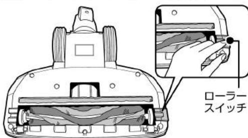
ローラースイッチを押すと、回転ブラシのロックが解除されるので、図の様に引き上げて下さい。
